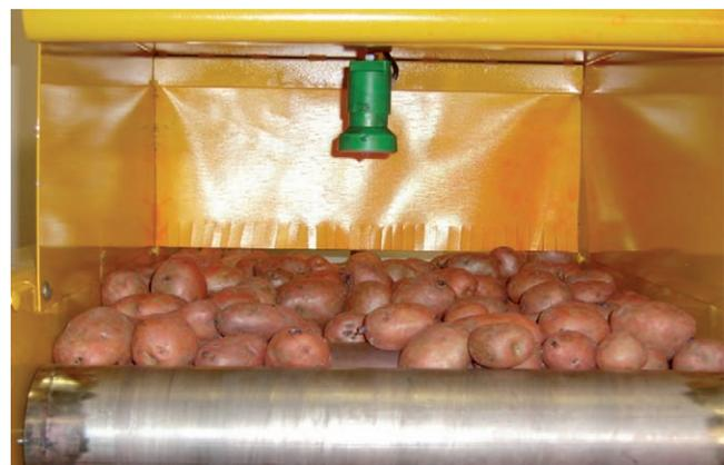
**Foto 4.** Máquina estacionaria de ultra bajo volumen. La boquilla en la parte superior asperja el producto químico mientras los tubérculos giran sobre la cinta transportadora.
