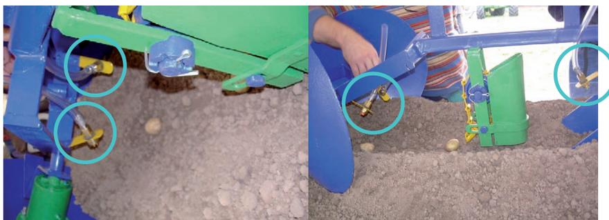
**Foto 7.** Máquina plantadora con aspersión a la plantación. Las boquillas de aspersión van dirigidas al surco de plantación previo al tapado de tubérculo.
