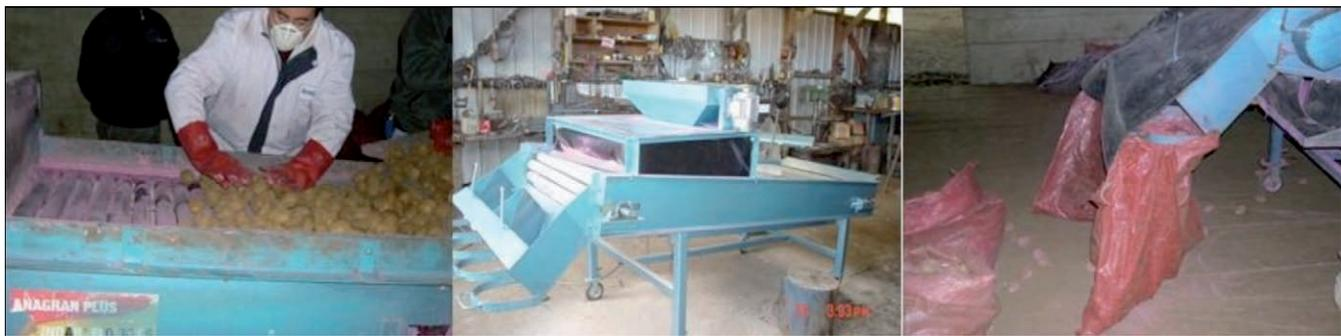
**Foto 1.** Máquina estacionaria de aplicación para formulaciones en polvo. Los tubérculos son transportados hacia la caja, donde un trompo pulveriza el producto.
